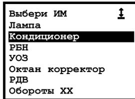
Используя клавиши  $\uparrow\downarrow$ , установите курсор на нужной Вам строке и, затем, нажмите клавишу  $\leftarrow$ . Тестер перейдет в режим готовности управления конкретным исполнительным механизмом.
